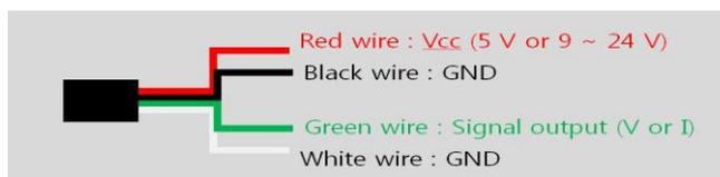
※ 若极性连接错误，将损坏或破坏探头。
