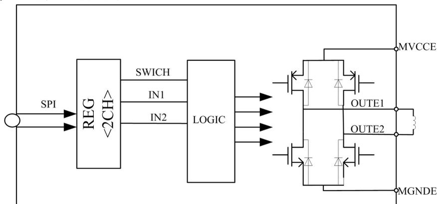
直流电机（摄像机中用于 IR-CUT）驱动采用 S P I 输入控制方式，通过写寄存器 2 C h 来控制 H 桥的输出：
