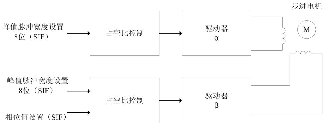
上图中模块是一个步进电机驱动内部示意图。下面的一些设置可以用来执行一系列的控制
