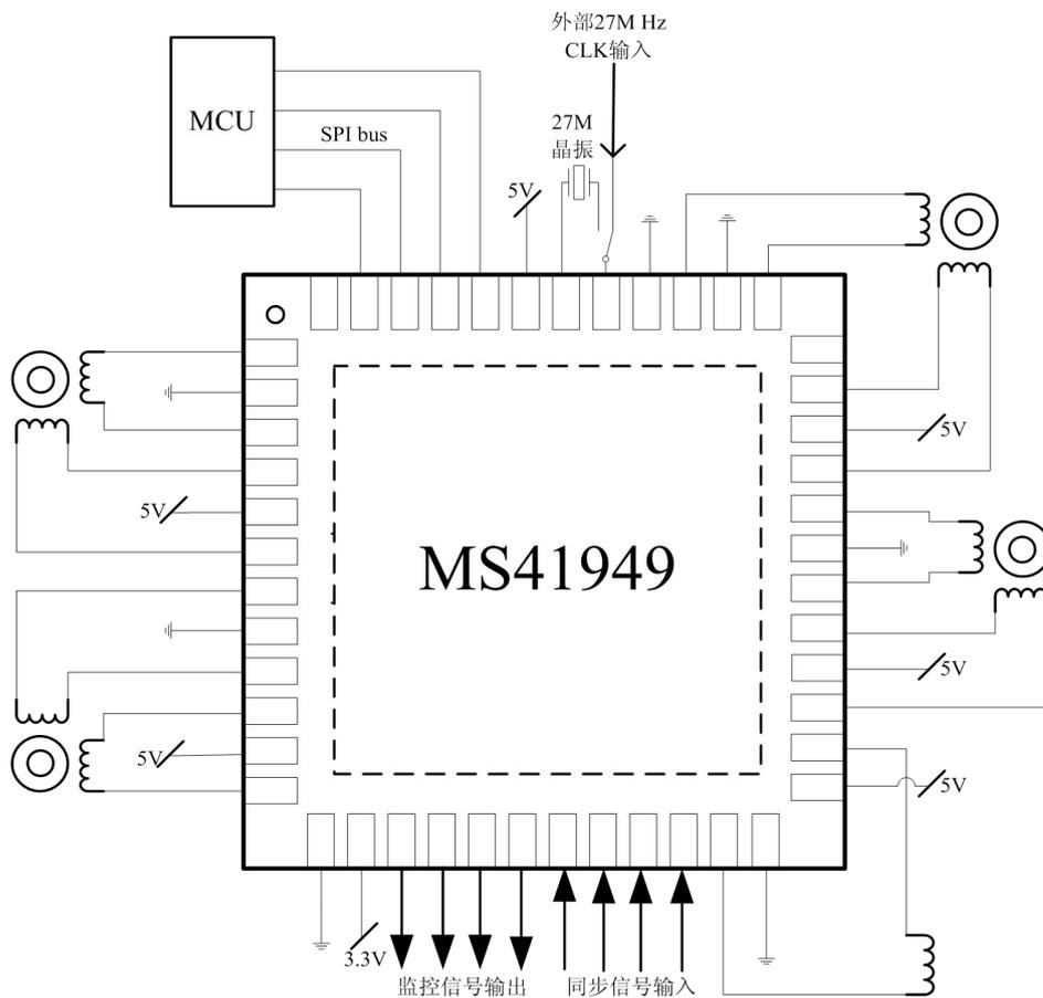
1. MS41949 具有背部散热 pad，大功率应用时必须接地。
