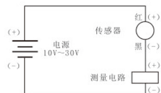
输出类型5（电流输出）接线图
