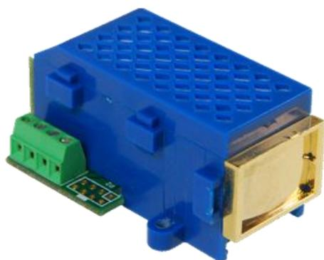
HTS-SF6 是一种基于单光源双光束非色散红外测量技术 (NDIR) 的红外气体传感器，专为 SF<sub>6</sub> 的检漏而设计。先进的红外传感器具有卓越的线性和重复性，确保长期稳定可靠的测量。
