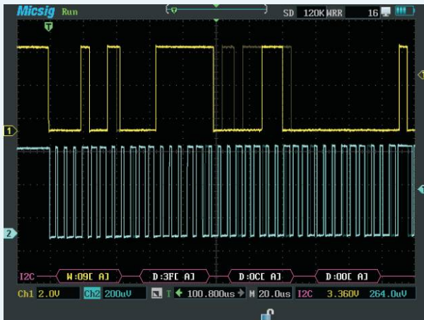
I2C总线解码图形模式
