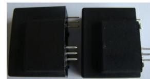
TBC25LAH 多量程闭环型电流传感器的初、次级之间是绝缘的，可用于测量直流、交流和脉冲电流。
