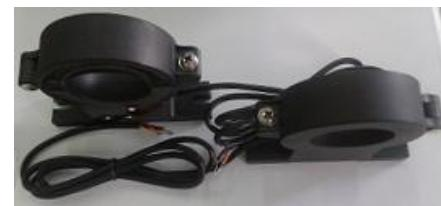
TKC-KD 系列可拆卸霍尔电流变送器是应用霍尔效应原理开发的新一代电流传感器，能在电隔离条件下测量交流、脉冲以及各种不规则波形的电流。
