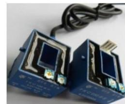
TKC-BSD/BRD 系列开环型霍尔电流变送器的初、次级之间是绝缘的，用于控制、测量交流和脉冲电流。
