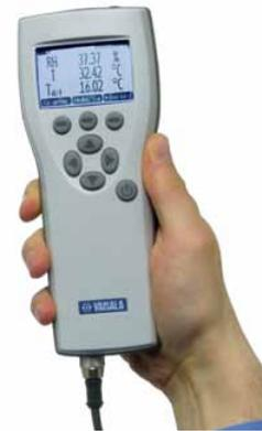
维萨拉DRYCAP®手持式露点仪DM70是现场校验DMT340变送器的理想选择。
