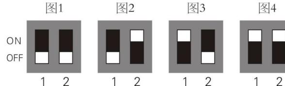
图1所示：拨码开关对应选择温度测量范围为0~50℃。
